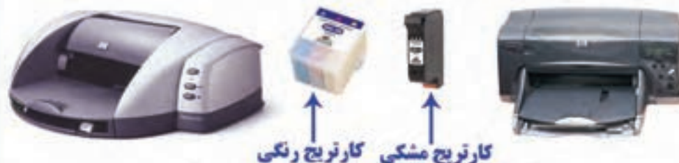
شکل (۳-۲۰) نمونه‌هایی از چاپگر جوهر افشان و کارتریج‌های آن
