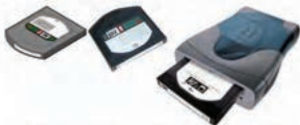
شکل (۴-۱۰) جاز درایو و حافظه جاز با ظرفیتهای یک و دو گیگابایت
