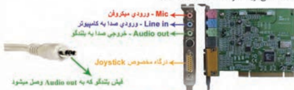
شکل (۴-۵) کارت صدا و اجزای آن
