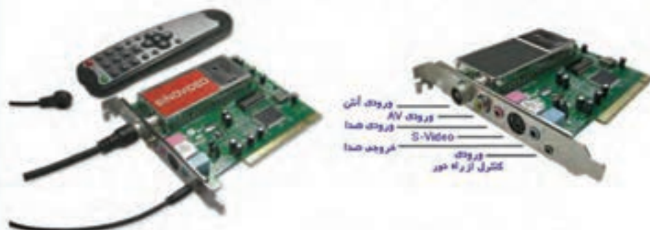
شکل (۲-۶) کارت تلویزیون ، کنترل از راه دور و درگاههای کارت تلویزیون
