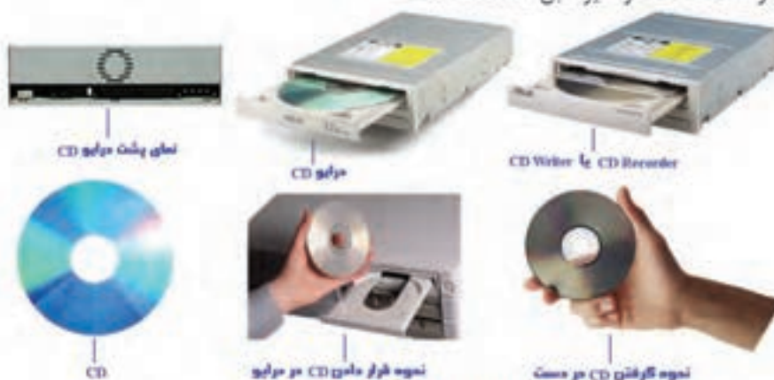
شکل (۴-۱۲) درایو و دیسک فشرده (CD)
