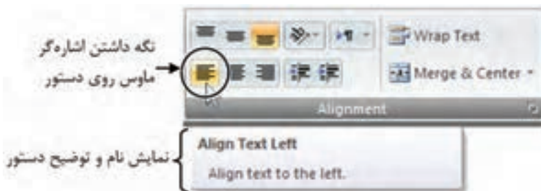
شکل ۵-۱ نمایش نام و توضیح دستور در زمان نگه داشتن اشاره‌گر ماوس روی آن
