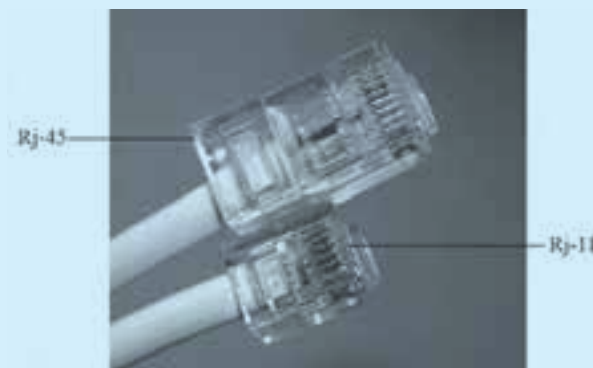
شکل ۵-۸ کابل Rj-11 و Rj-45
